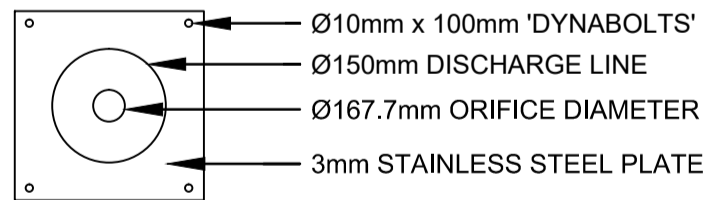
ORIFICE PLATE DETAIL N.T.S.
